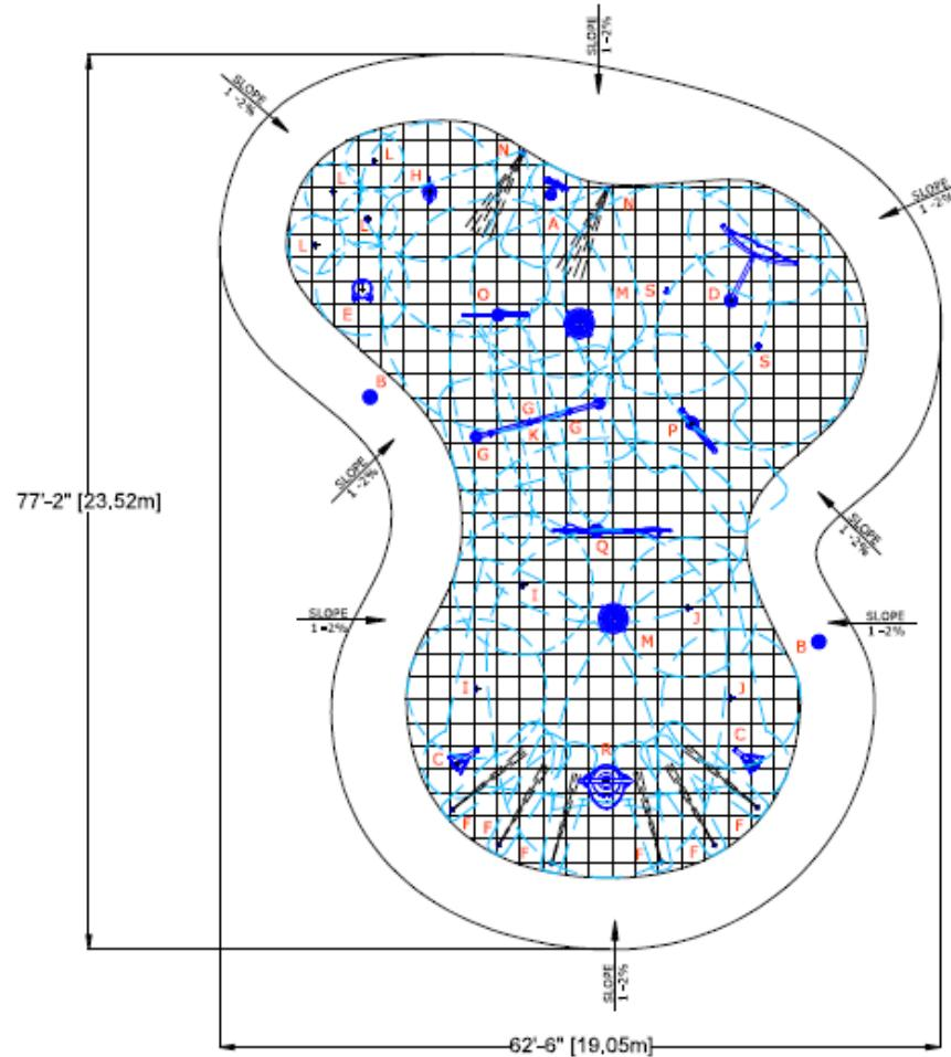
MINIMUM 5'[1,5m] SPRAY FREE CONCRETE AREA ALL AROUND THE SPLASHPAD IS RECOMMENDED BY VORTEX
